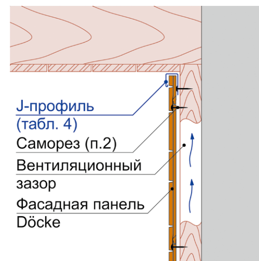
Рис. 25 Примыкание фасадных панелей Döcke к горизонтальной поверхности
